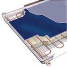
El absorbedor, está fabricado con una aleación  $Al_2O_3$  con solución coloidal de níquel como tratamiento selectivo y el intercambiador de calor interno, en forma de serpentín, va embutido en él gracias a una técnica transformadora. La configuración del serpentín permite el conexionado según el sistema Tichelmann.
